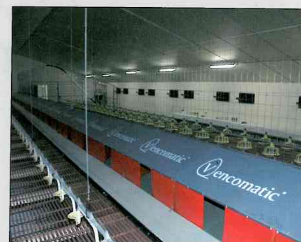
▲ Le matériel répond à un bon compromis entre technicité et confort de travail : pondoirs automatiques à un étage (Vencomatic), chaînes d'assiettes Laïca et des lignes d'abreuvoirs Spark Cup (Roxell), machieline automatique de mise en alvéole des œufs (Prinzen).
